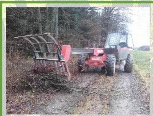
Auf Wunsch werden die abgeschnittenen Äste per Teleskopplader mit Reissiggabel weggeräumt. Durch Hundegang-Lenkung und Teleskoparm können auch weit entfernte Äste vom Weg aus erfasst werden.
